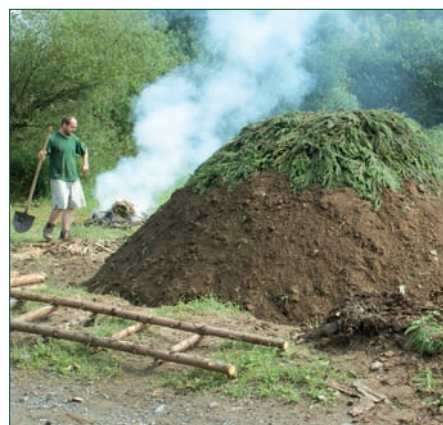
Pokrývání milíře svrchním pláštěm (Pec pod Čerchovem - Dřevorubecké slavnosti 2009).
